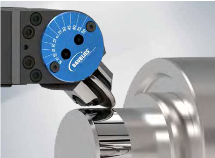
Einrollenwerkzeug variabel Single-roller burnishing tool variable
