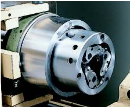
Umlaufender Gewinderollkopf RR 22-2 auf einer Gewinderollmaschine
