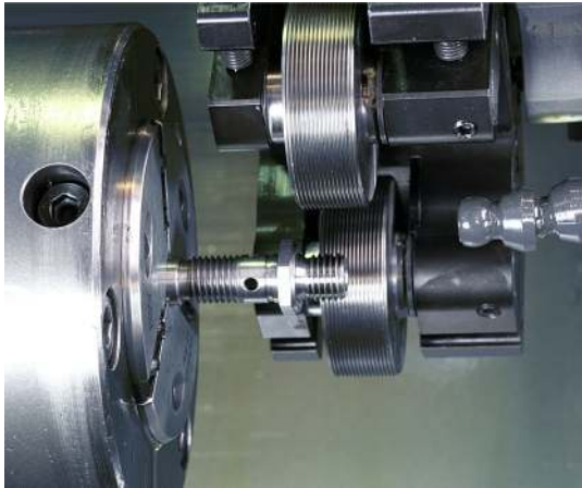
Ein fertig gerolltes Gewinde vor dem Bund
