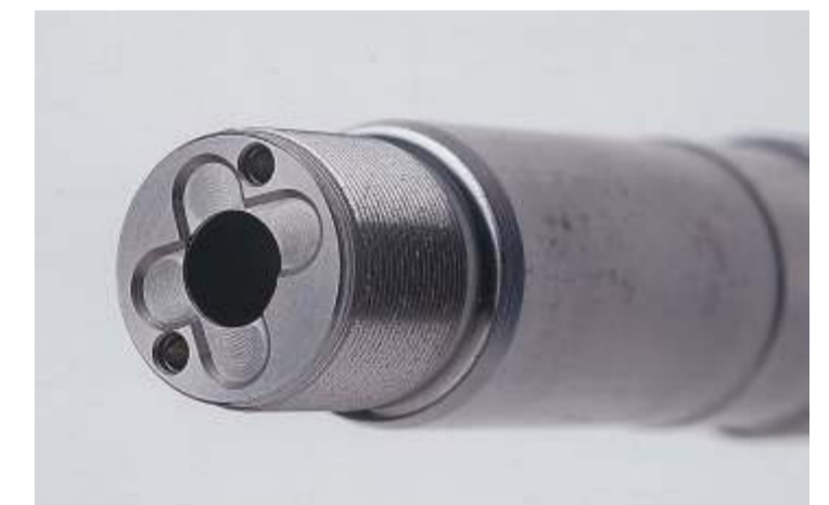
Ein Original „Common Rail“-Gewinde, das mit dem WAGNER®-Seitenrollwerkzeug gerollt wurde
